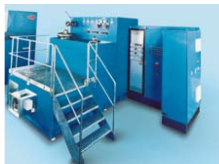
Испытательный стенд для определения перепадов давления
